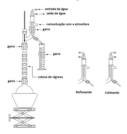
**79.** O esquema representa a aparelhagem para uma destilação simples.
